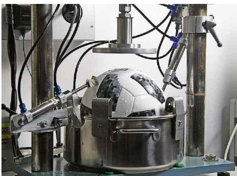
Bei 250-maligem Eintauchen in einen Wasserbehälter darf der Ball nur minimal schwerer werden.
