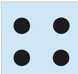
Abtrennung Abfangkasten 28 x 28 x 1- 1,5 und Durchlasslöcher ca. 7 im Durchmesser Anzahl beliebig. Auch eckig möglich oder lange Schlitze.
