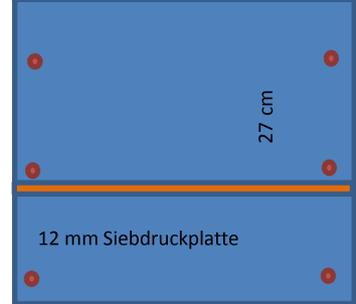
Die Filterkammer mit Winkeln in der ausgefrästen Nut befestigen
